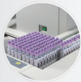
Конечный накопитель вмещает одновременно до 300 пробирок. Отсюда пользователь может выбрать пробирки, для которых необходимы дальнейшие анализы.
