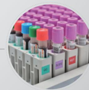
Можно использовать специальные штативы с отличающимися штрих-кодами для разделения проб по назначению: "QC" - контроль качества, "Slide" - только изготовление мазков и "RET" только на ретикулоциты. Это позволяет максимально упростить доставку пробирок к анализатору.
